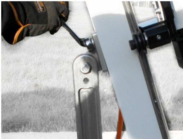
c. Atlaisvinkite viršutinės atramos varžtą ir pakreipkite bėgį į norimą padėtį atgal arba pirmyn.
