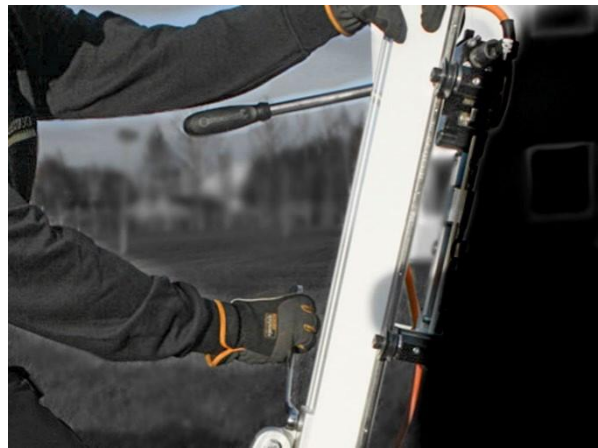
d. Priveržkite apatinės atramos varžtą ir viršutinį bei apatinį galinės atramos varžtus.
