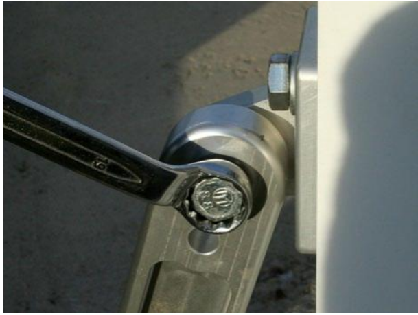
a. Atlaisvinkite viršutinį varžtą ant galinės atramos.
