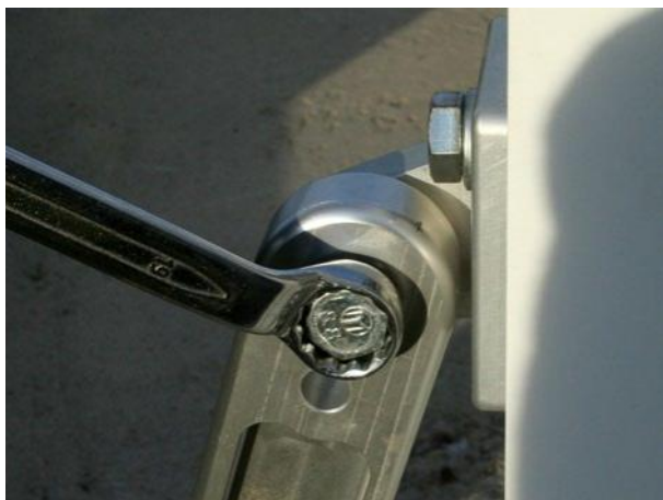
f. Tada priveržkite viršutinį varžtą ant galinės atramos.
